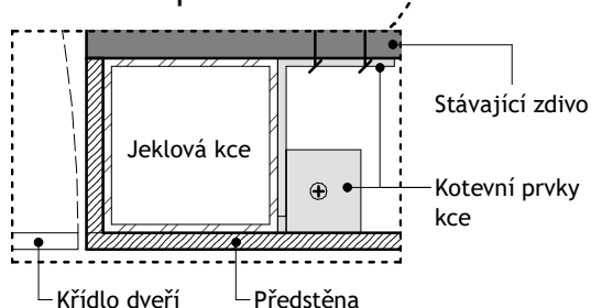
Princip navázání na předstěnu
